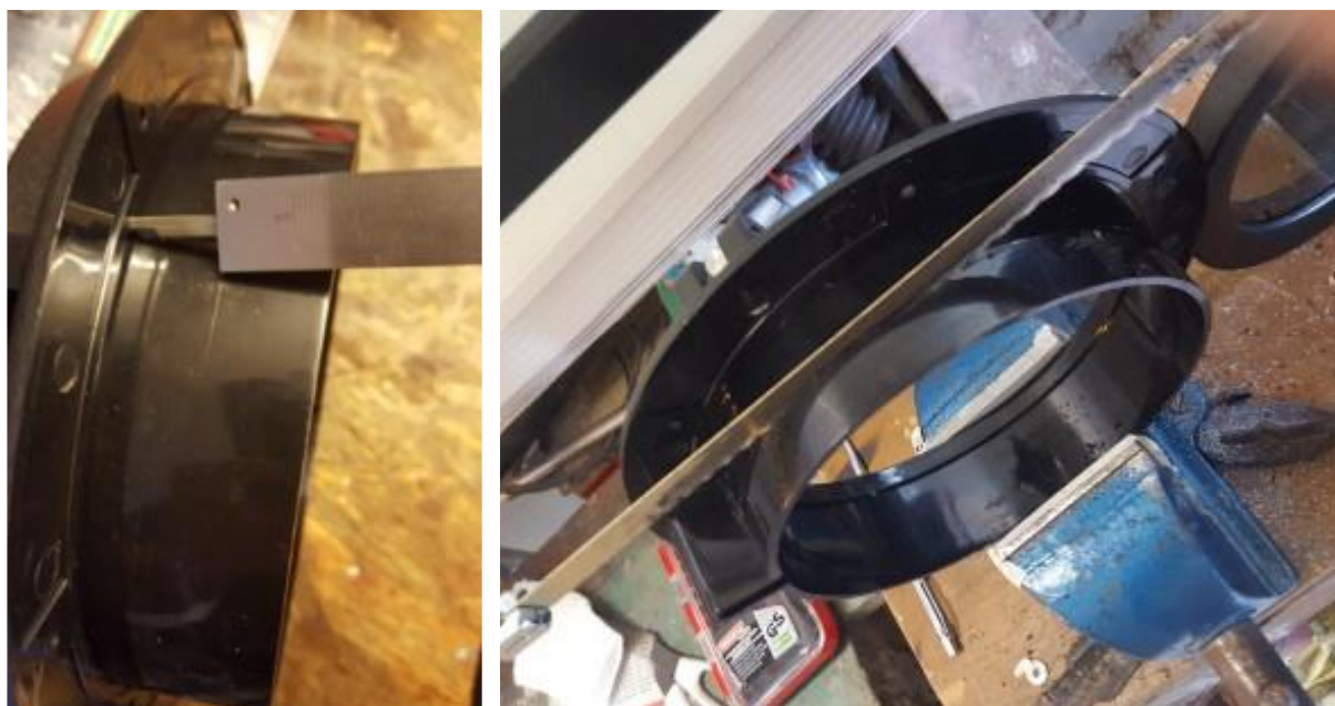
Abb. 59: Anreißen (links) und Zuschnitt (rechts) des Fensterrahmens
