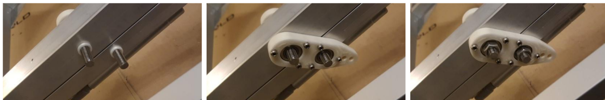
Abb. 9: Einbaureihenfolge zur Montage der Hebelarme
