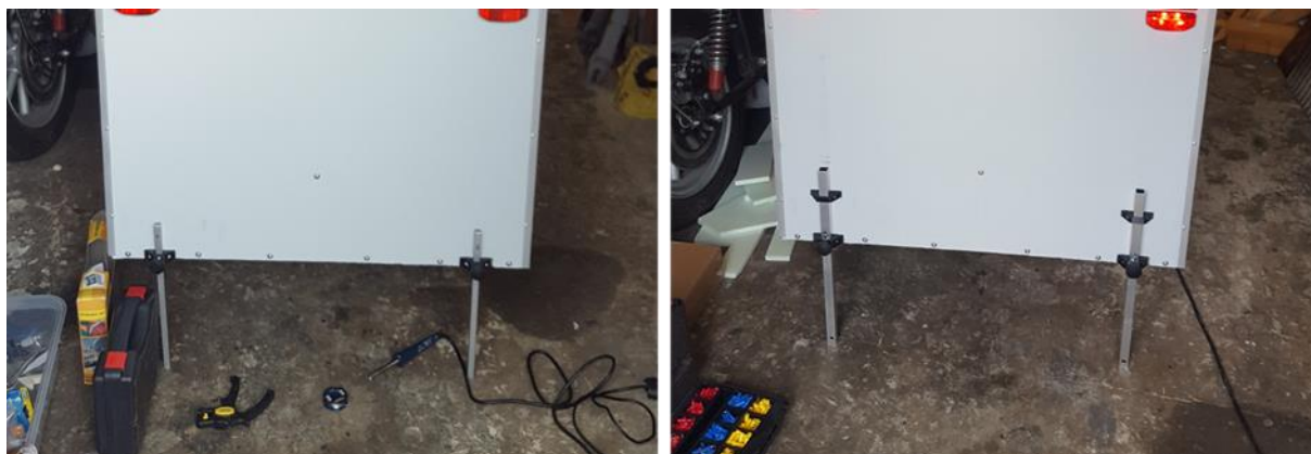
Abb. 31: Vergleich der alten Stützen (link) mit den neuen Stützen (rechts)
