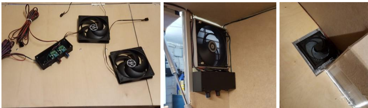
Abb. 64: Lüftersteuerung und Lüfter
