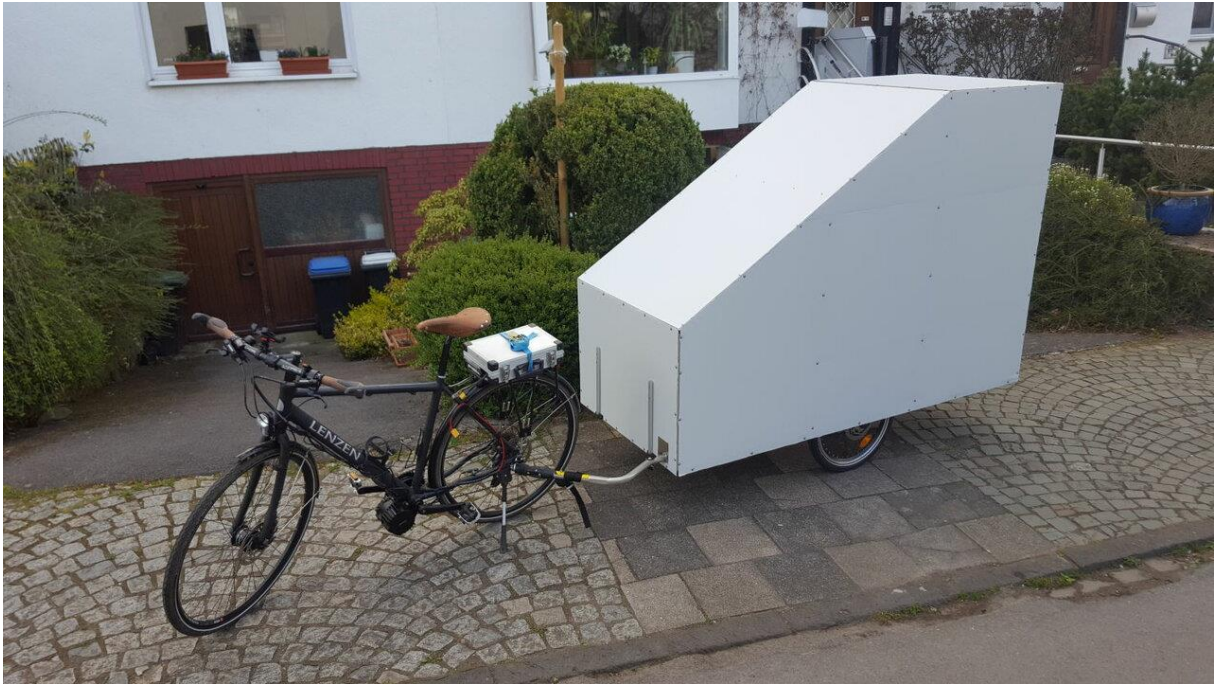
Abb. 39: Zwischenstand noch Anbringung der folierten Hohlkammerplatten
