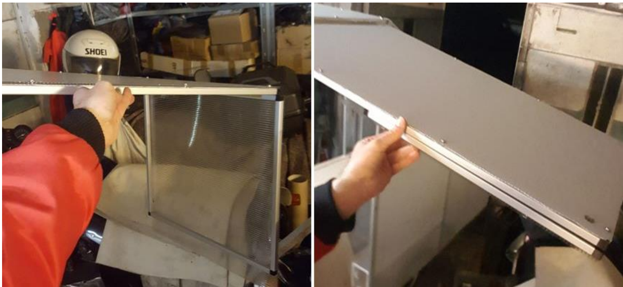
Abb. 45: Türscharnier zur Reduzierung der Länge im aufgeklappten Zustand
