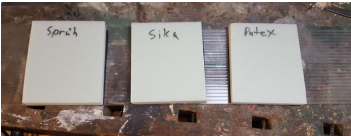
Abb. 54: Probestücke zum Vergleich der Klebwirkung
