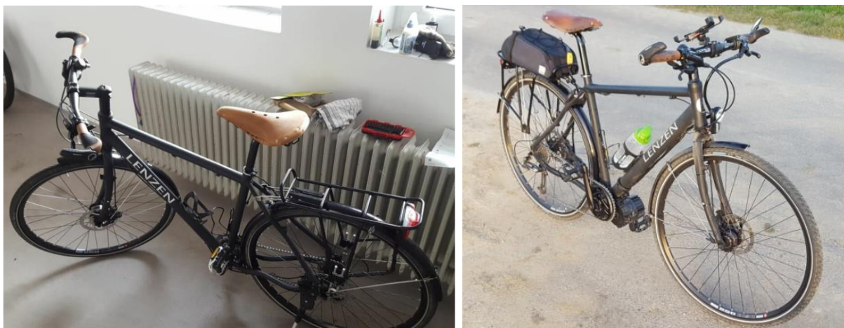
Abb. 24: Mein Trekkingrad vor (links) und nach (rechts) der Umrüstung zum Pedelec
