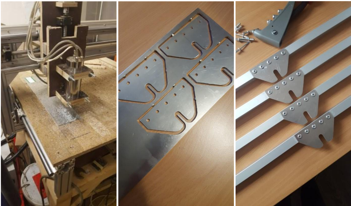
Abb. 3: Herstellung der Radaufnahmebleche
