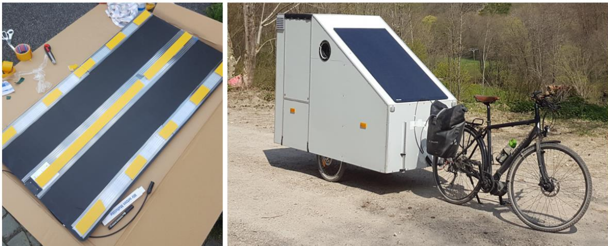
Abb. 67: Verkleben des Solarpanels (links) sowie fertig montiertes Panel (rechts)
