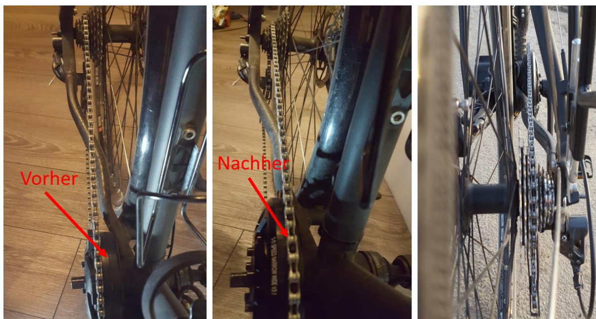
Abb. 27: Altes + neues Kettenblatt (links + mitte) und Kettenlinie mit neuem Kettenblatt (rechts)
