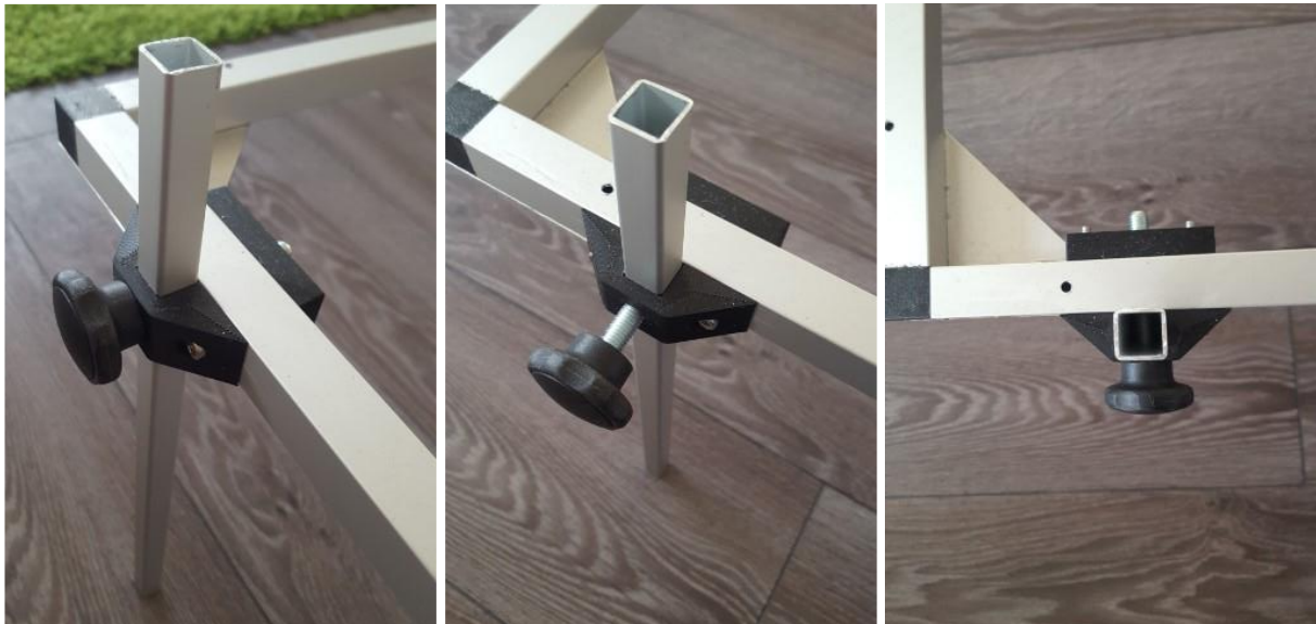
Abb. 29: Montierte Stütze aus 13,5 mm Aluminiumrohr und 3D-gedrucktem Halter
