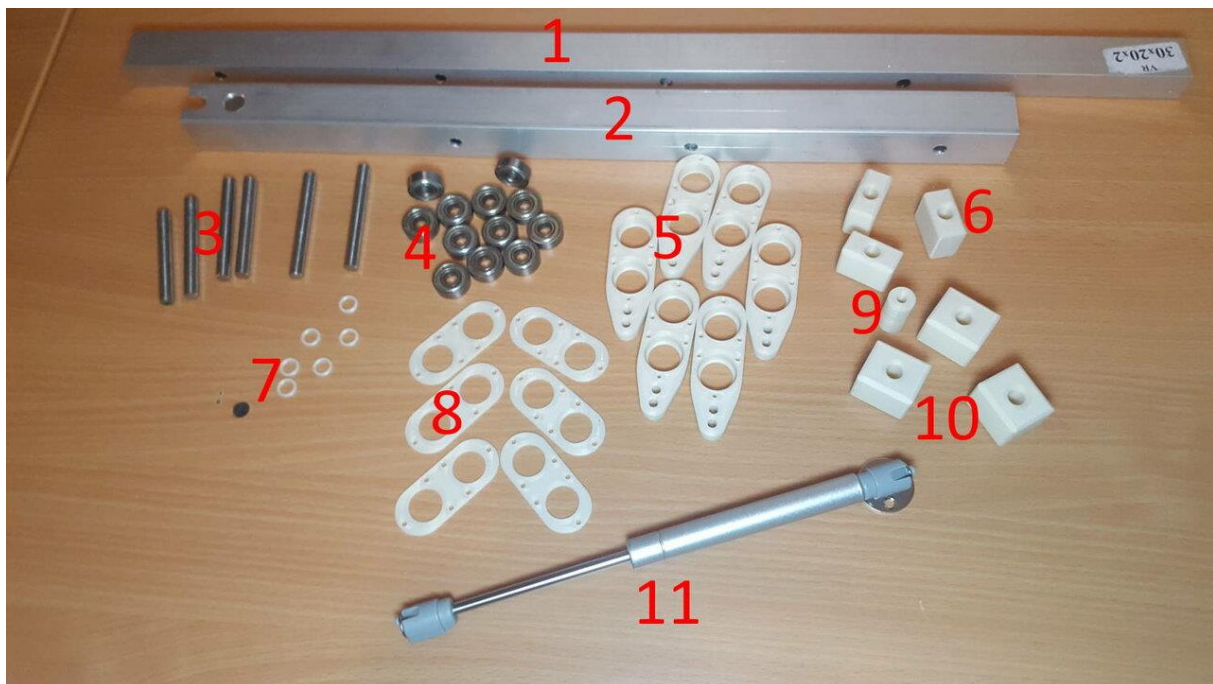
Abb. 8: Bestandteile des Auflaufmechanismus
