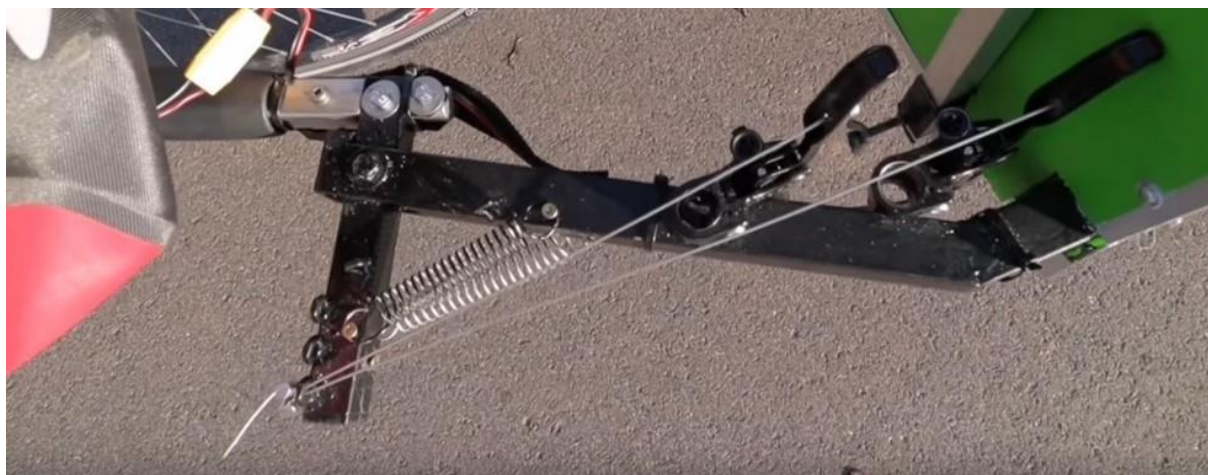
Abb. 5: Auflaufbremse des "Kreher Imperial" von Rene Kreher [3]
