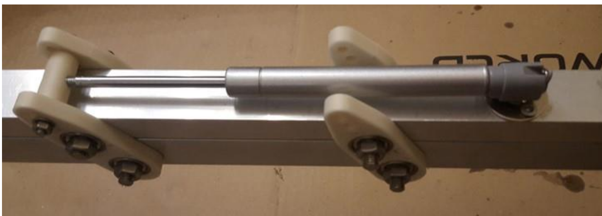
Abb. 10: Dämpfer auf der Unterseite des Auflaufmechanismus
