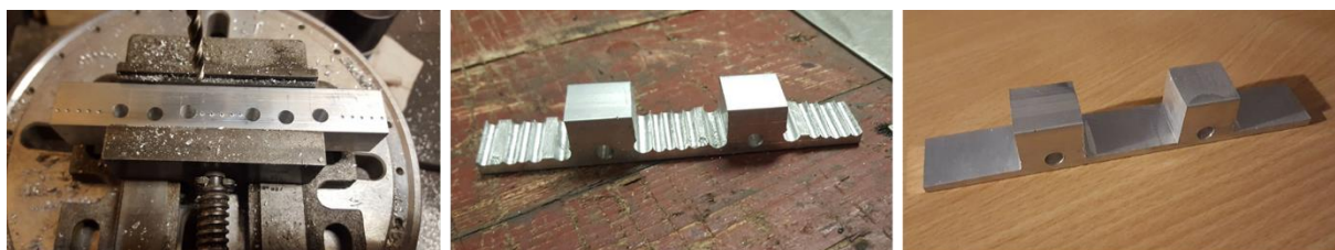
Abb. 15: Fertigungsprozess der Bremssattelaufnahme
