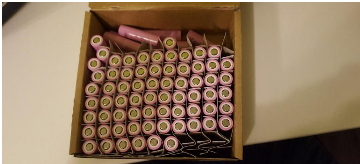
Abb. 18: Einzelzellen für den Aufbau des Akkupacks
