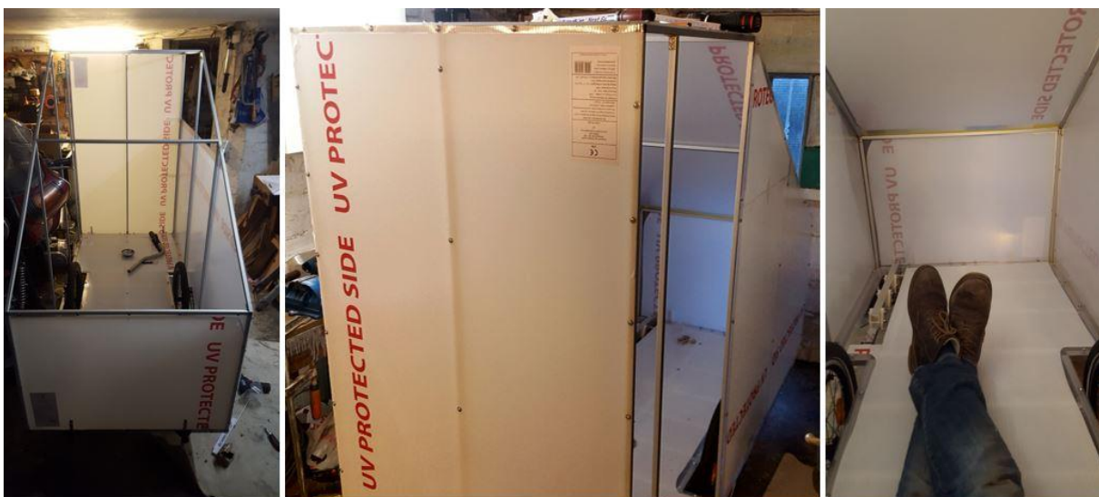
Abb. 37: Verkleidung mit Hohlkammerplatten und erste Sitzprobe
