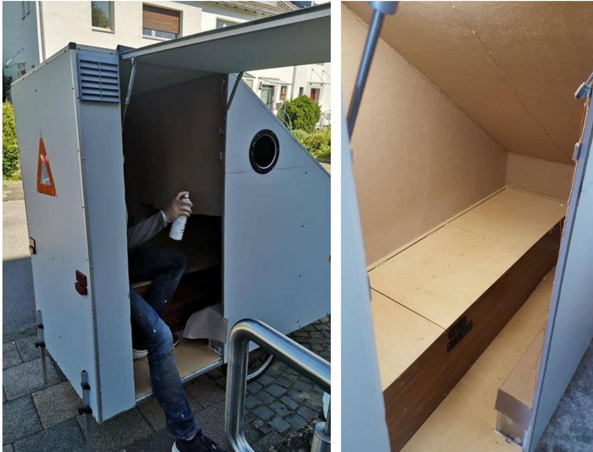
Abb. 58: Aufbringen des Sprühklebers (links) und fertig gefilterter Innenraum (rechts)
