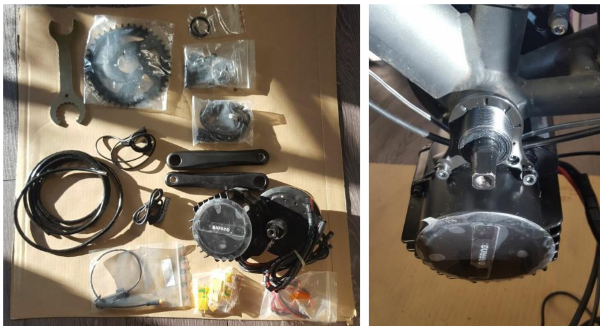
Abb. 25: Bestandteile des Umrüstsatzes (links) sowie eingesetzter Motor (rechts)
