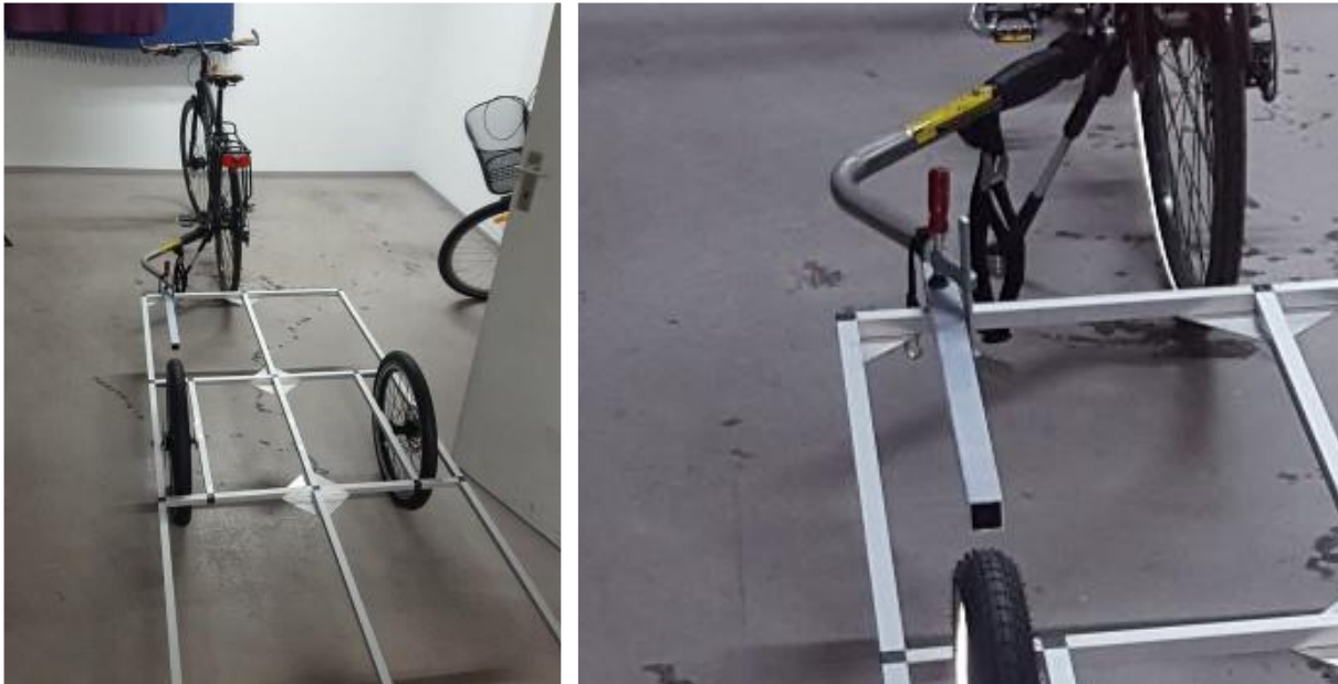
Abb. 4: Provisorische Befestigung des Anhängers am Fahrrad
