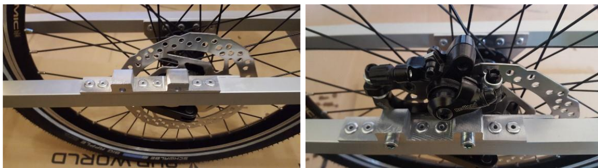
Abb. 16: Montage des Bremssattels
