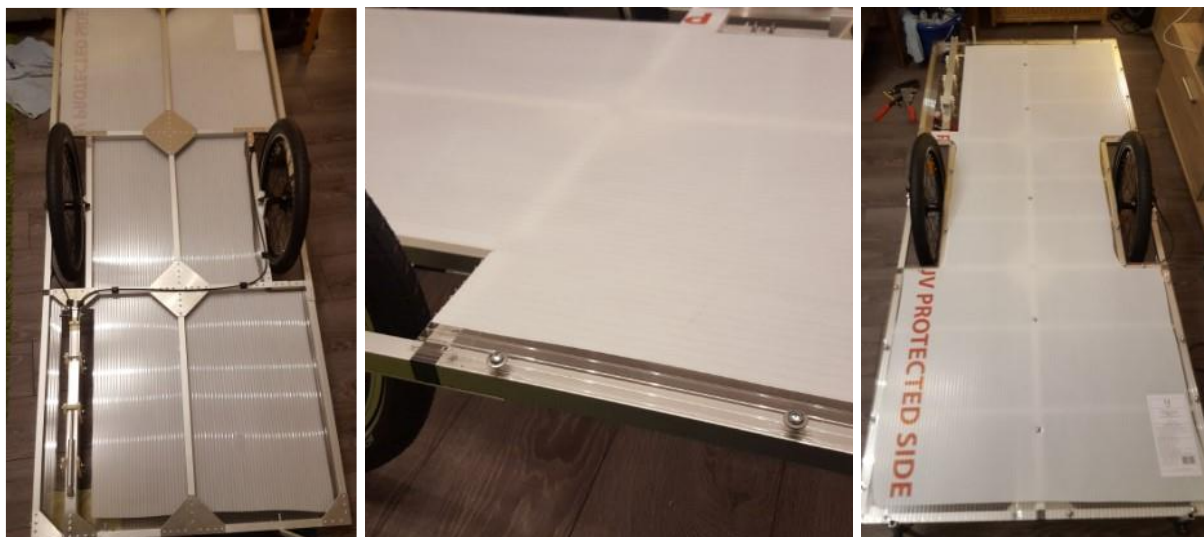
Abb. 28: Fahrgestell mit verschraubter Bodenplatte, links noch ohne Querstreben
