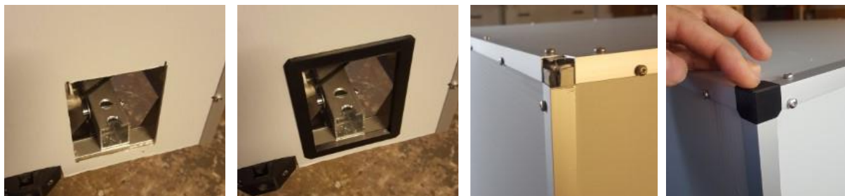
Abb. 51: 3D-Druck Abdeckungen für Deichselöffnung und Anhängerecken
