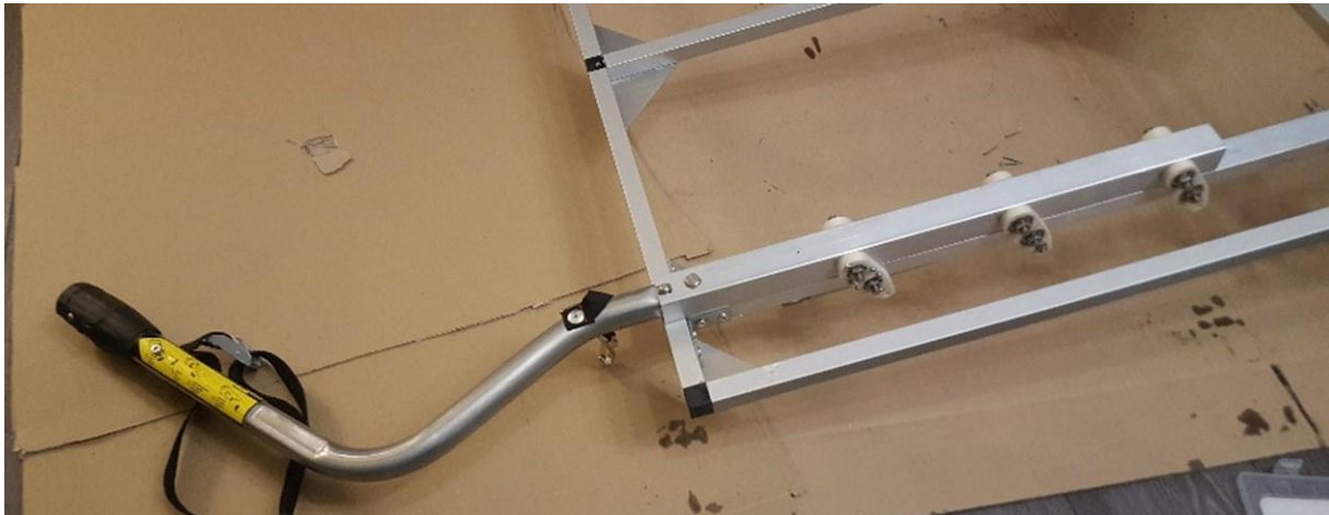
Abb. 13: Montierter Auflaufmechanismus mit eingeschobener Deichsel
