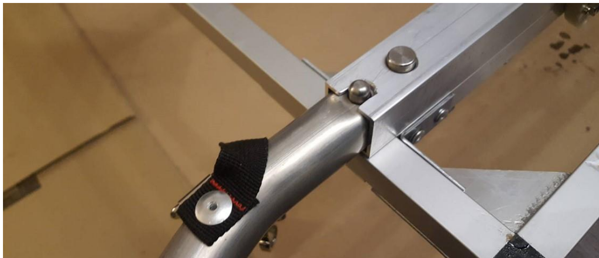
Abb. 12: Einschub der Deichsel in das Deichselrohr
