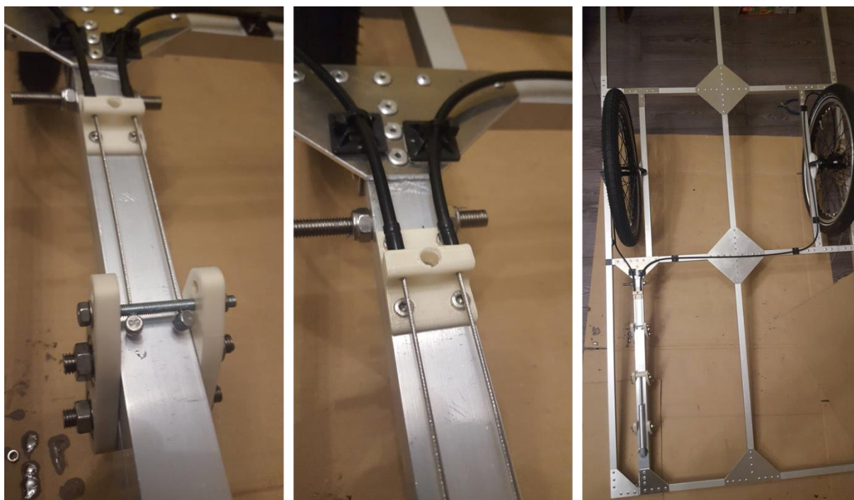
Abb. 17: Bremszugverlegung auf der Anhängerunterseite
