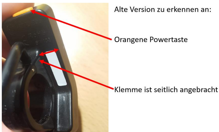
Abb. 26: Merkmale des alten / schlechteren "Eggrider V2" Displays
